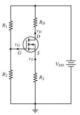
**Find:**  $v_{GS}; v_{DS}; i_D$ .
