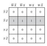
**Figure 12.34** Karnaugh map for the function  $\overline{W} \cdot X \cdot \overline{Y} \cdot Z + \overline{W} \cdot \overline{X} \cdot \overline{Y} \cdot Z +$  $W \cdot \overline{X} \cdot \overline{Y} \cdot Z + W \cdot X \cdot \overline{Y} \cdot Z$
